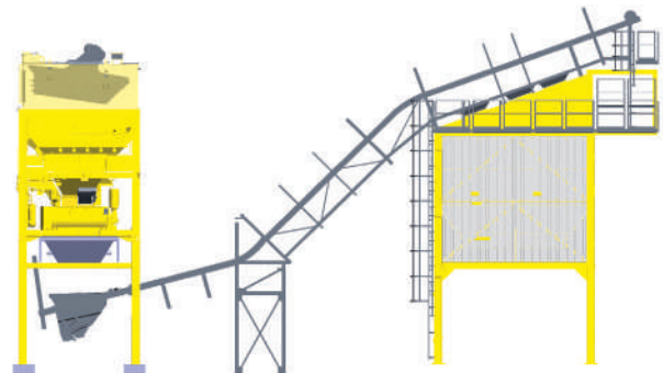
поворотный скиповый путь для прямой разгрузки и/или 36 + 45 т бункер-накопитель
