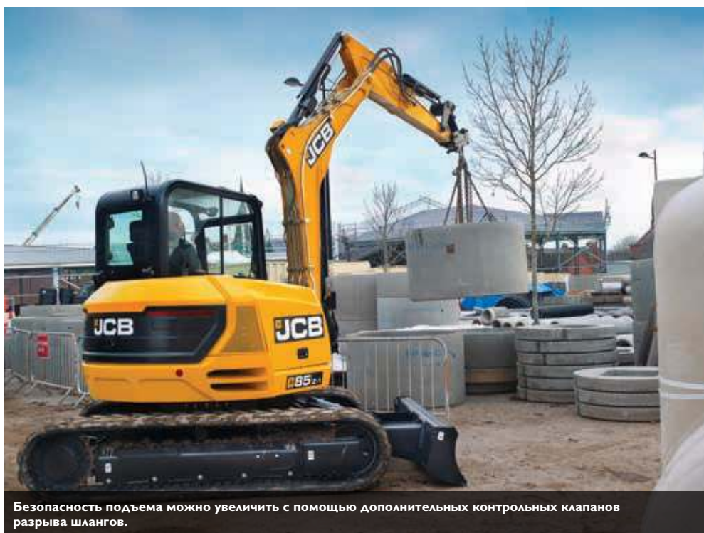
Прочная защита гидроцилиндра стрелы отлично экранирует механизм при загрузке.
