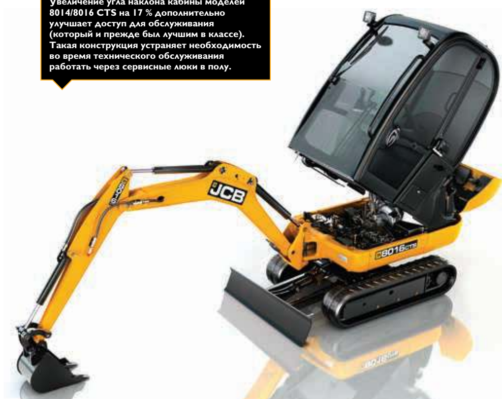
Широко открывающийся задний капот на пневматической распорке обеспечивает удобный доступ для выполнения регулярных проверок.
