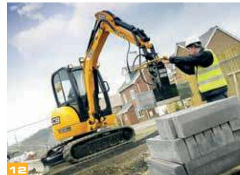
Мощный бульдозерный отваль Maxi-Lift позволяет легко опускать и поднимать шину над грунтом, чтобы увеличить высоту згрузки поверх бортов.
