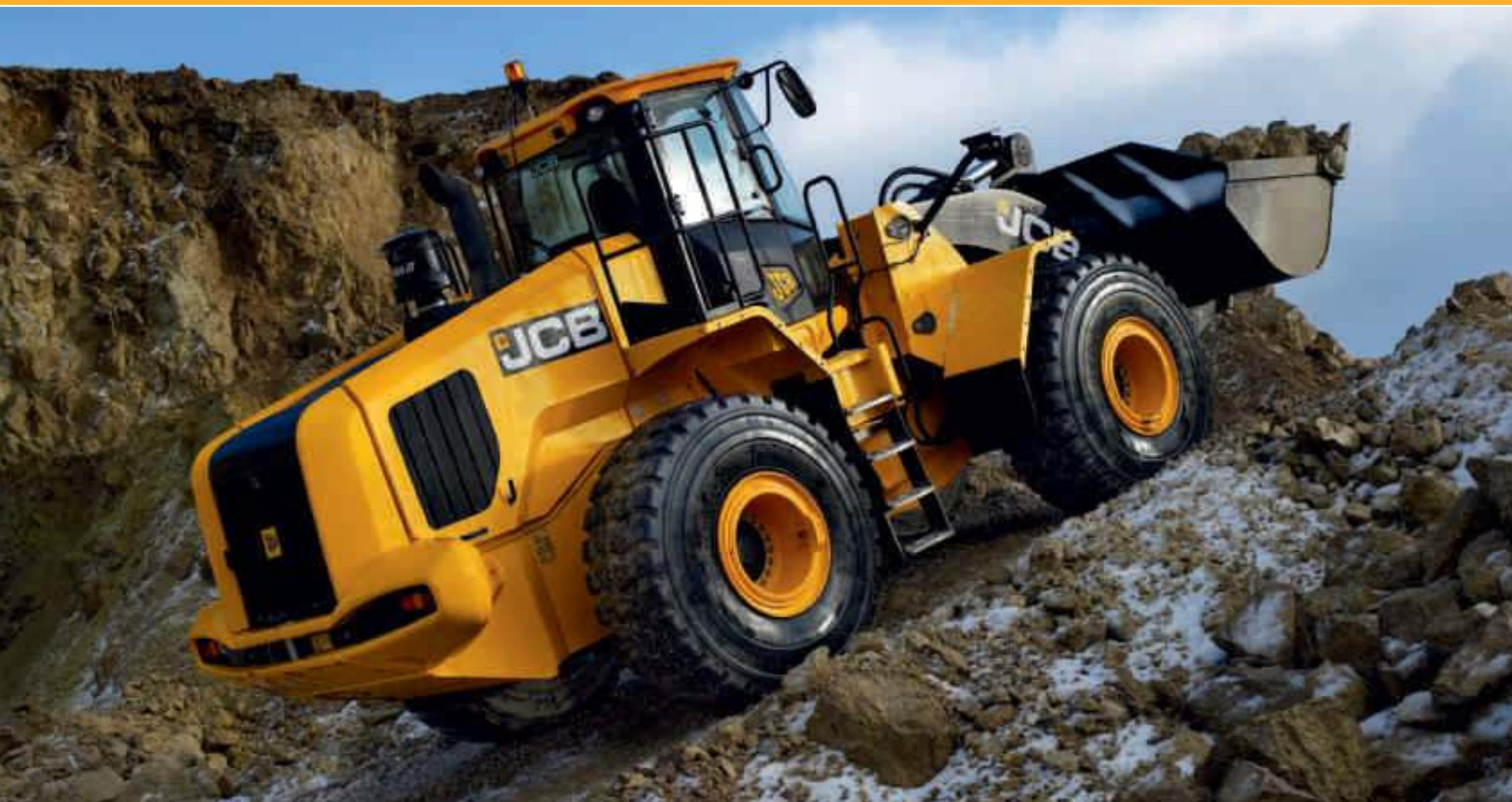
Общая мощность двигателя: 216 кВт (290 л.с.) Эксплуатационная масса: 23 800 кг Опрокидывающая нагрузка при полном повороте: 15 300 кг Стандартный объем ковша: 4 м<sup>3</sup>
