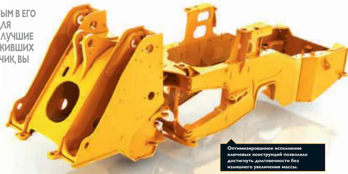
Оптимизированное исполнение ключевых конструкций позволило достигнуть долговечности без излишнего увеличения массы.
