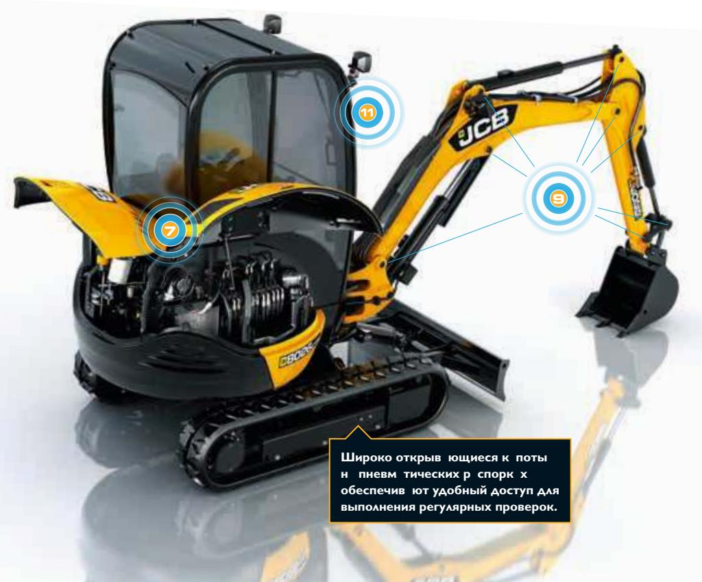
Широко открывющиеся к потоку пневматических спорок обеспечивают удобный доступ для выполнения регулярных проверок.
