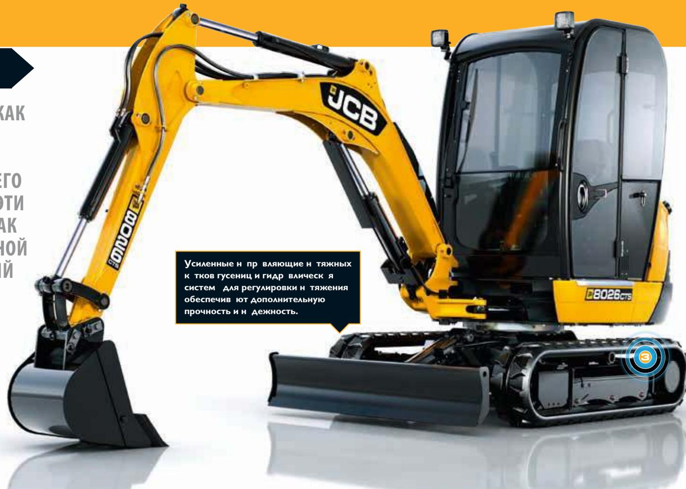
Усиленные и пружинящие в тяжелых условиях гусеницы и гидравлическая система для регулировки натяжения обеспечивают дополнительную прочность и надежность.
