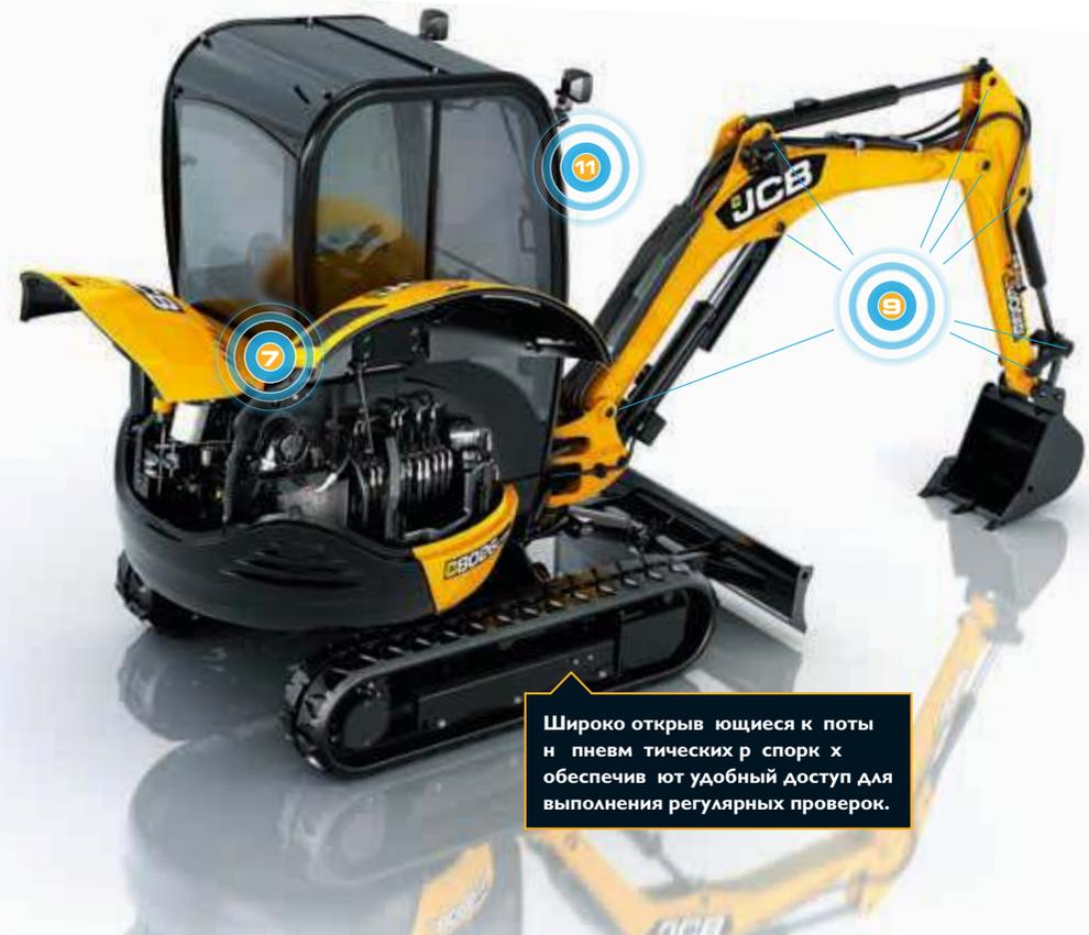
Широко открывающийся капот обеспечивает удобный доступ для выполнения регулярных проверок.
