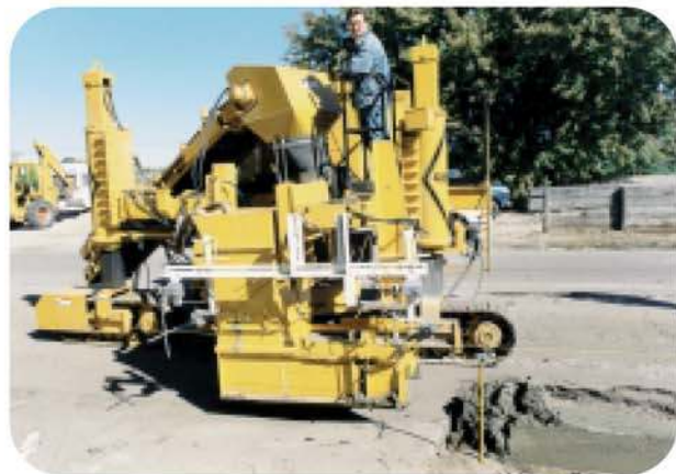
Этот бетоноукладчик GT-3600 имеет гильотинный депрессор.
