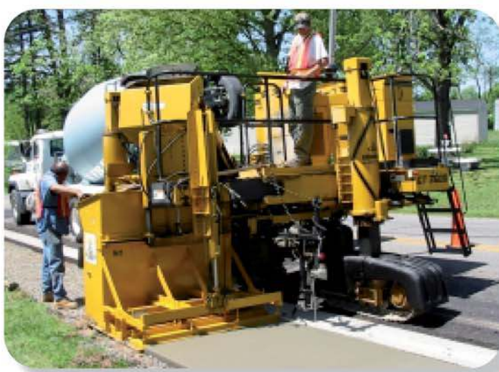
GT-3600 (фото сверху) с "Позиционированием всех гусениц" (АТР) обеспечивает простую регулировку для бетонирования тротуара или (фото внизу) бордюра и водостока для имеющегося бетонного покрытия. Рулевое управление и уровень базируются на основании существующего бордюра или могут базироваться относительно прямой линии.
