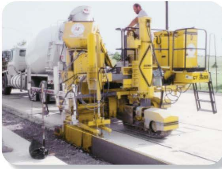
GT-3600 (фото сверху) с "Позиционированием всех гусениц" (АТР) обеспечивает простую регулировку для бетонирования тротуара или (фото внизу) бордюра и водостока для имеющегося бетонного покрытия. Рулевое управление и уровень базируются на основании существующего бордюра или могут базироваться относительно прямой линии.
