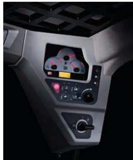
Панель управления содержит средства диагностики машины, электронного управления дроссельной заслонкой и зажиганием минипогрузчика с бортовым поворотом.
