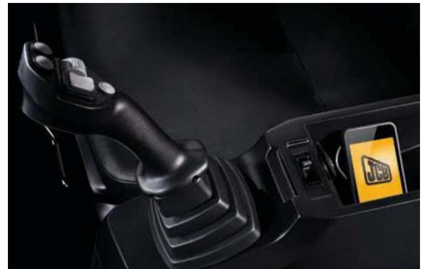
Опциональный многофункциональный джойстик позволяет оператору управлять более широким диапазоном гидравлического и весового оборудования. В левом подлокотнике также имеется отсек для хранения личных вещей.
