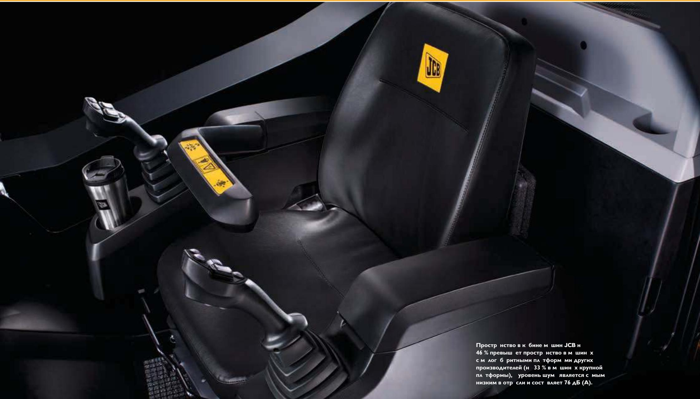
Пространство в кабине м/шин JCB на 46 % превышает пространство в м/шинах с малогабаритными платформами других производителей (на 33 % в м/шинах крупной платформы), уровень шума является самым низким в отрасли и составляет 76 дБ (A).
