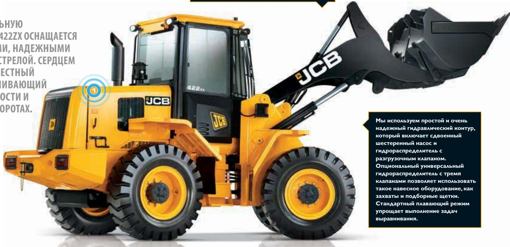
Мы используем простой и очень надежный гидравлический контур, который включает сдвоенный шестеренный насос и гидрораспределитель с разгрузочным клапаном. Опциональный универсальный гидрораспределитель с тремя клапанами позволяет использовать такое навесное оборудование, как захваты и подборные щетки. Стандартный плавающий режим упрощает выполнение задач выравнивания.
