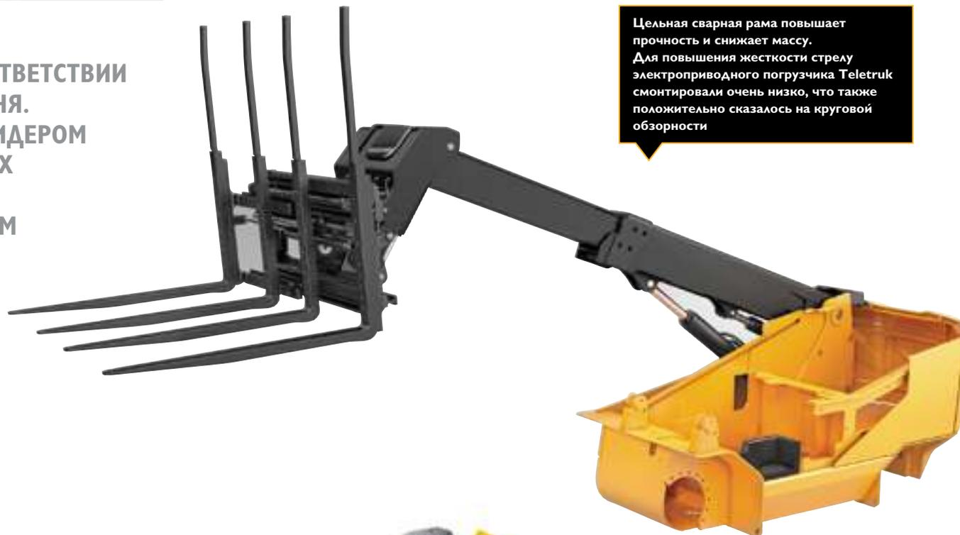
Цельная сварная рама повышает прочность и снижает массу. Для повышения жесткости стрелу электроприводного погрузчика Teletruk смонтировали очень низко, что также положительно сказалось на круговой обзорности.
