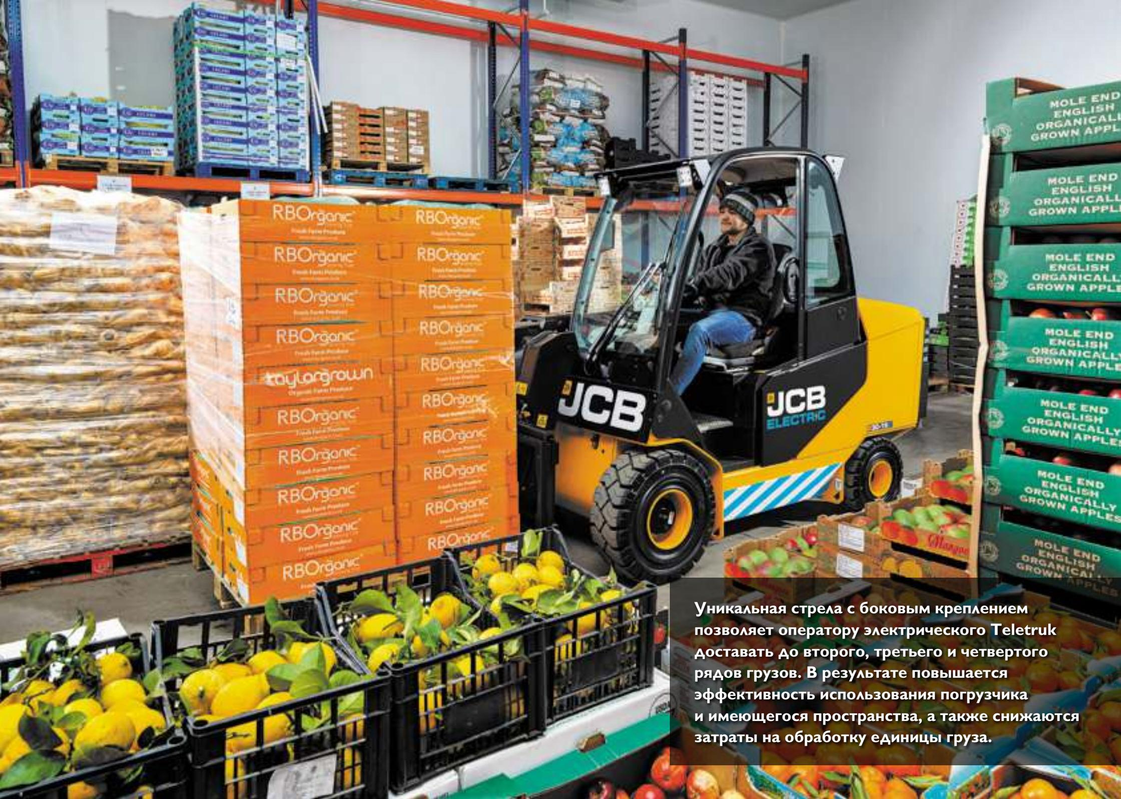
Уникальная стрела с боковым креплением позволяет оператору электрического Teletruk доставать до второго, третьего и четвертого рядов грузов. В результате повышается эффективность использования погрузчика и имеющегося пространства, а также снижаются затраты на обработку единицы груза.
