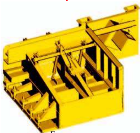
Гидравлическая система регулирования оборудования для формирования кромки.
