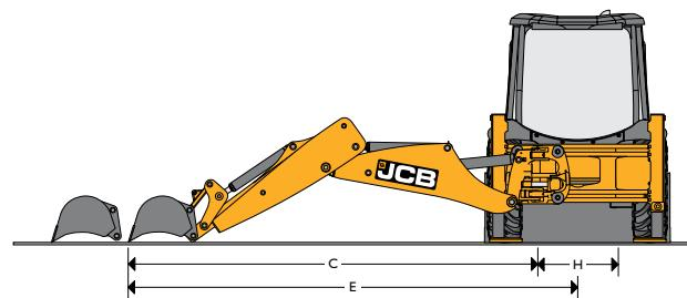
Экскаватор-погрузчик 5CX ECO МАКС. МОЩНОСТЬ ДВИГАТЕЛЯ 5CX ECO: 88 кВт (118 л. с.) МАКС. ГЛУБИНА КОПАНИЯ: 6,51 м ГРУЗОПОДЪЕМНОСТЬ: 1,3 м<sup>3</sup>
