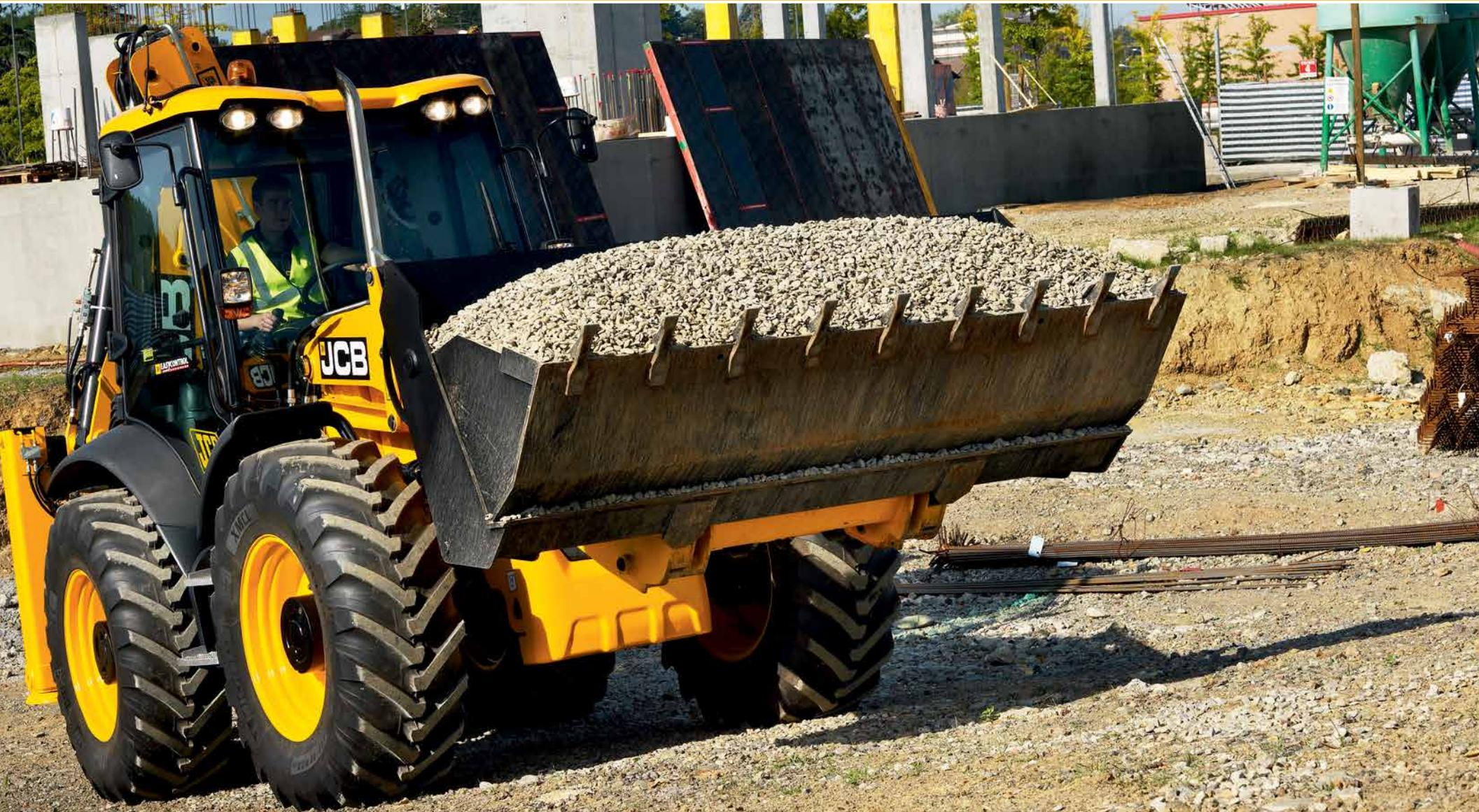
МАКС. МОЩНОСТЬ ДВИГАТЕЛЯ 5CX ECO: 88 кВт (118 л. с.) МАКС. ГЛУБИНА КОПАНИЯ: 6,51 м ГРУЗОПОДЪЕМНОСТЬ: 1,3 м<sup>3</sup>
