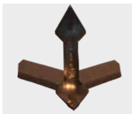
Лемех с двойным сердечником и стрелчатой лапой
