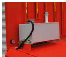
Бортовая гидравлика для поперечного ленточного транспортера
