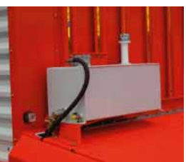
Бортовая гидравлика для поперечного ленточного транспортера
