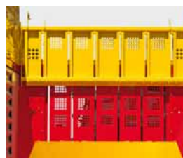
Створка автоматической погрузки складывается гидравлически
