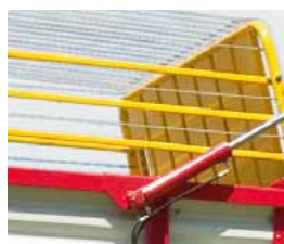
Надставка для транспортировки сена складывается гидравлически
