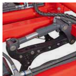
Защита от камней NOVA гидравлическая
