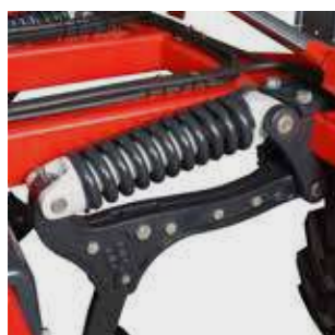
Защита от камней NOVA механическая
