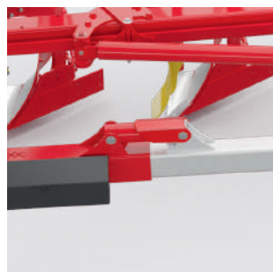
Гидравлическая настройка ширины захвата первого корпуса
