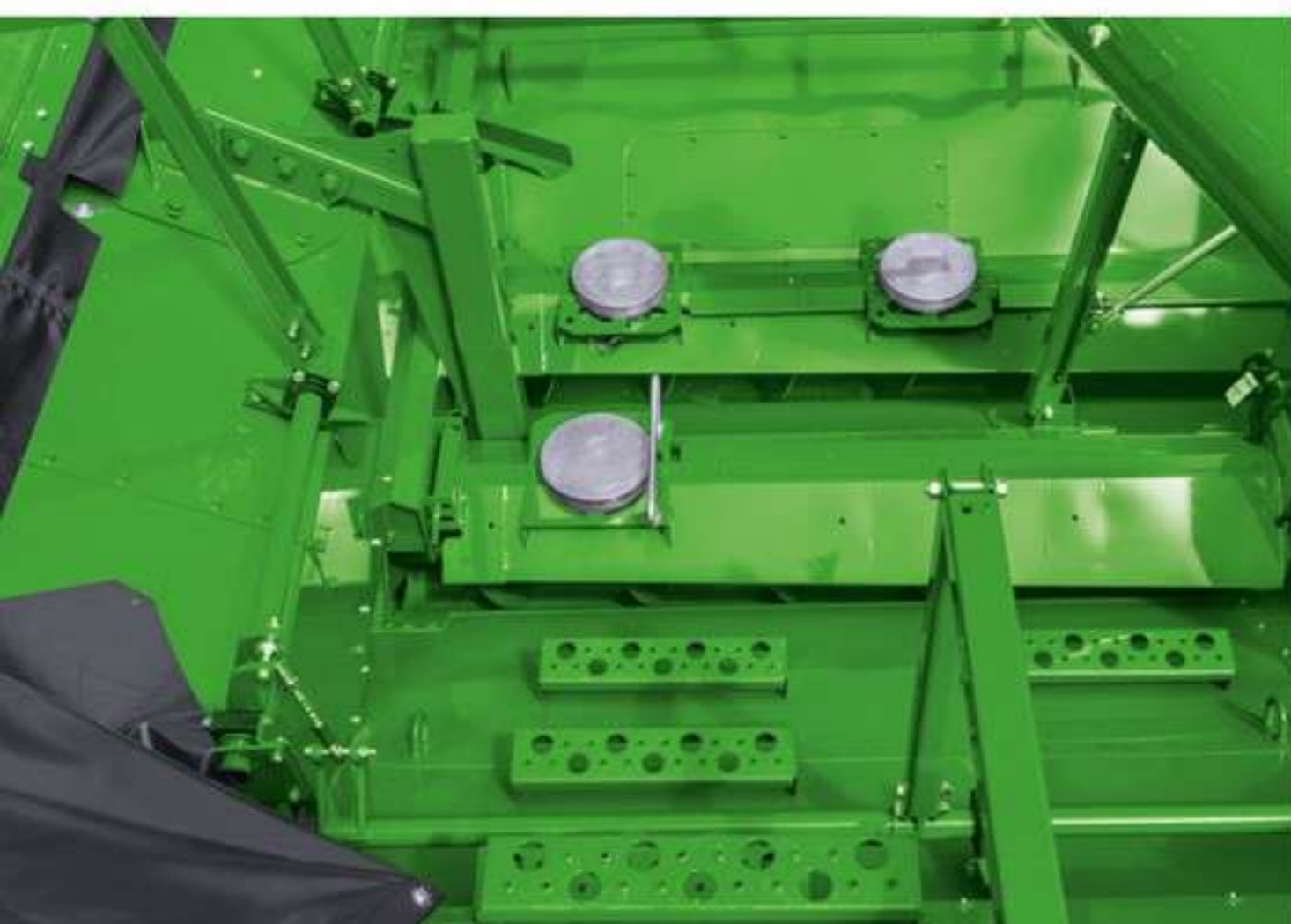
Три датчика определяют вес зерна.
