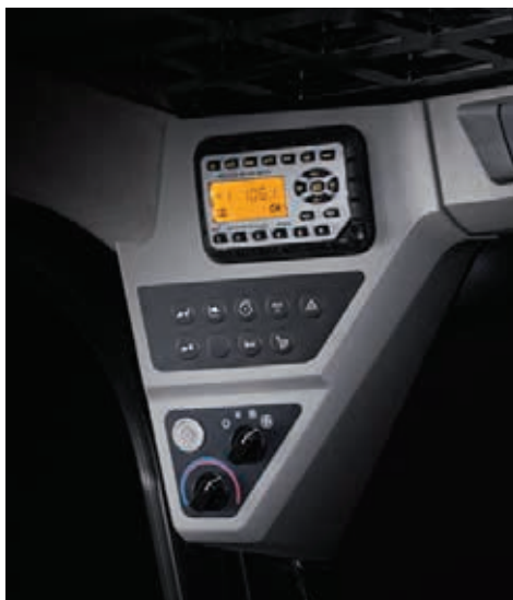
Система управления параметрами машины удобно расположена в верхней части кабины, в поле зрения оператора.
