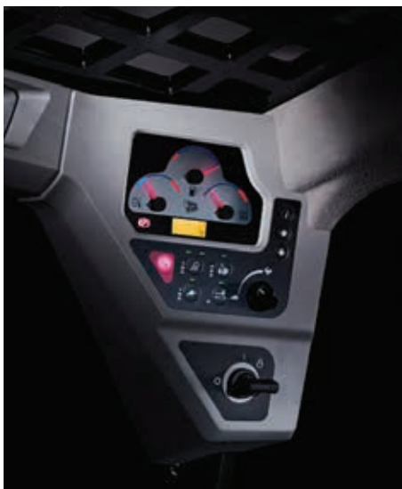
Правая панель содержит средства диагностики машины, электронного управления дроссельной заслонкой и зажиганием минипогрузчика с бортовым поворотом.
